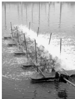
FIGURA 9: AIREADOR DE PALETA IMPULSADO POR UN MOTOR DE DIESEL DE 8 HP
